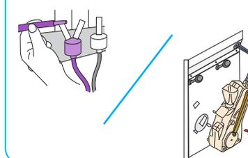
Entfernen Sie gemäß den Anweisungen des Maschinenherstellers Brühereinheit, Mischkammern und Schläuche.
