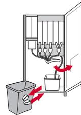
Öffnen Sie die Tür, leeren Sie den Abfallbehälter. Reinigen und trocknen Sie ihn und setzen Sie ihn wieder ein.
