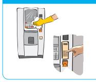
Schließen Sie die Tür und säubern Sie die Außenseite des Gehäuses mit einem feuchten Tuch. Führen Sie den Endtest des Geräts durch
