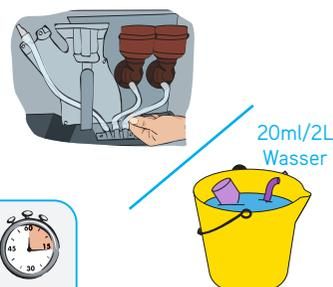
Bereiten Sie die Lösung mit Suma Café Liquid und warmem Wasser vor. Nehmen Sie Mischer und Schläuche heraus. Tauchen Sie alles in einen Eimer mit der vorbereiteten Reinigungslösung. Lassen Sie die Lösung 15 Minuten einwirken. Lassen Sie alles trocknen und setzen Sie die Teile anschließend wieder zusammen.
