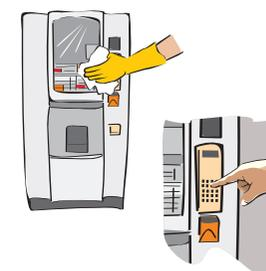
Schließen Sie die Tür und säubern Sie die Außenseite des Gehäuses mit einem feuchten Tuch. Führen Sie den Endtest des Geräts durch.
