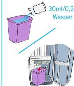
Bereiten Sie eine Lösung mit Suma Café MilkClean vor. Tauchen Sie den Ansaugschlauch in die Lösung ein und starten Sie das Reinigungsprogramm. Den Vorgang mit sauberem kaltem Wasser wiederholen, um alle Teile nachzuspülen. Leeren Sie den Abfallbehälter. Reinigen und trocknen Sie ihn und setzen Sie ihn wieder ein.
