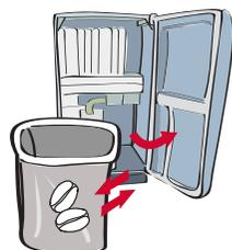
Öffnen Sie die Tür, leeren Sie den Kaffeesatzbehälter. Reinigen und trocknen Sie ihn und setzen Sie ihn wieder ein.
