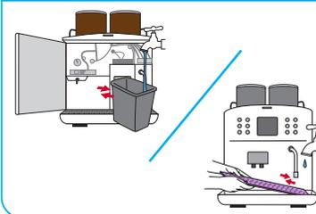
Leeren Sie den Kaffeesatzbehälter. Reinigen und trocknen Sie ihn und setzen Sie ihn wieder ein. Reinigen Sie das Innere des Gehäuses. Entfernen Sie Abtropfgitter und -schale. Spülen Sie beides gründlich ab, trocknen Sie es und setzen Sie es wieder ein. Führen Sie den Endtest des Geräts durch.
