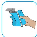
Reinigen Sie die Dampfdüse nach jedem Gebrauch mit einem Tuch.
