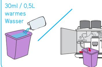
Bereiten Sie eine Lösung mit Suma Café MilkClean vor. Tauchen Sie den Ansaugschlauch in die Lösung ein und starten Sie das Reinigungsprogramm. Wiederholen Sie den Vorgang mit sauberem Wasser, um alle Teile gründlich auszuspülen.
