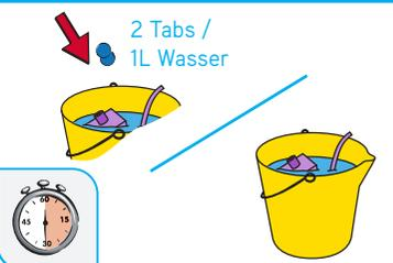
Lösen Sie Suma Café AutoTab in heißem Wasser auf. Lassen Sie Auslauf und Schläuche 30 Minuten in der Lösung einweichen. Gründlich mit sauberem Wasser abspülen. Trocknen lassen. Setzen Sie Auslass und Schläuche wieder zusammen.
