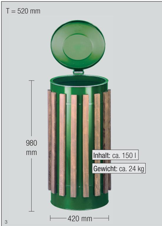
Der komplett verschließbare Abfallsammler für den Außenbereich, für 120 ltr. Abfallsäcke, Einfüllöffnung ca. 395 mm Ø. Mit verzinktem Klemmring zur Sackbefestigung. Durch die Holzleistenverzierung ist dieser Abfallsammler besonders für den Einsatz in Parkanlagen sowie auf Rastplätzen geeignet.
