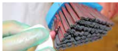
Abbildung 4a: Verunreinigung der Bürste durch Brownes Test schmutz.
