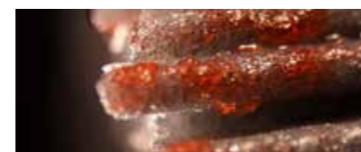
Abbildung 6b. Metalldetektierbare Borsten nach der Reinigung (160-fache Vergrößerung).
