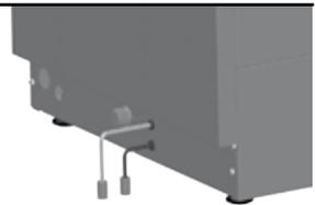
Der Dosierer wird werkseitig auf Maximalwert eingestellt und kann nach erfolgter Installation des Geschirrspülers - je nach Wasserhärte, Geschirrverschmutzung und des zu verwendenden Reinigers - entsprechend eingestellt werden.
