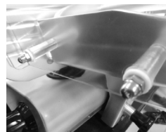
4. Закрутите две глухие гайки.
