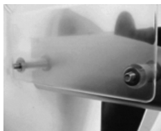
3. Inserire le due rondelle sui bulloni.
