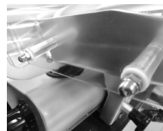
4. Nakręć dwie nakrętki kotłakowe.
