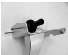
1. Τοποθετήστε και τις δύο βίδες στον κινούμενο δίσκο.
