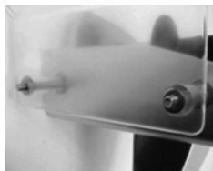
3. Установите две шайбы на винты.
