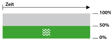
Lineare Leistungssteuerung bei neuer Mikrowellen-Invertertechnik. Beispiel: 50% Leistung (ca. 450 Watt)
