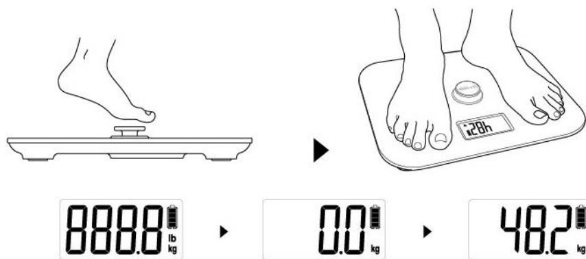
Drücken Sie mit Fuß oder Hand auf die Taste bis der Kondensator mittels Dynamo-Technologie voll geladen ist.
