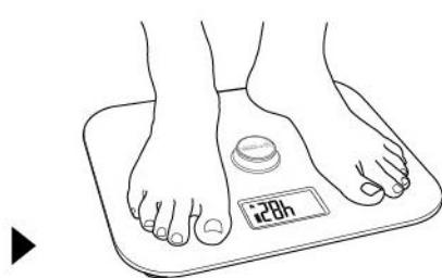
Presione con el pie o la mano el botón hasta que el condensador quede totalmente cargado mediante tecnología dinamo.
