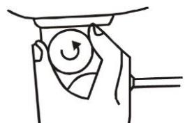
3.2 Estrarre prima di tutto la spina dalla presa e poi asportare dalla superficie di cottura elettrico il termostato automatico.
