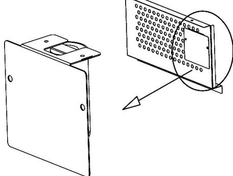
Retire la cubierta. La bombilla ultravioleta está sujetada a esta cubierta.
