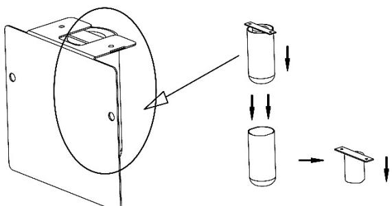
Retire la cubierta de la bombilla de luz ultravioleta tirando de ella hacia abajo y sustituya la bombilla.
