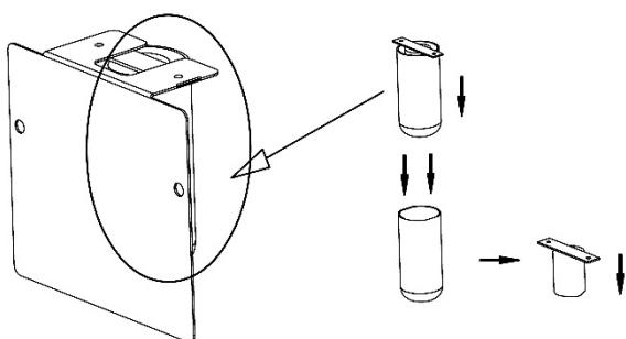
Behuizing van de UV-lamp naar onderen verwijderen en de lamp vervangen.
