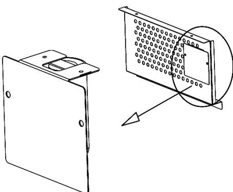
Afdekking verwijderen. De UV-lamp is hieraan bevestigd.
