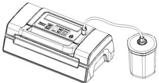
Füllen Sie das Vakuumiergut in den Behälter. Achten Sie darauf nicht zu viel Vakuumiergut einzufüllen. Verschließen Sie den Deckel.
