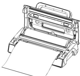
Mettere un'estremità del sacchetto sopra la barra di saldatura, ma non nella camera del vuoto.
