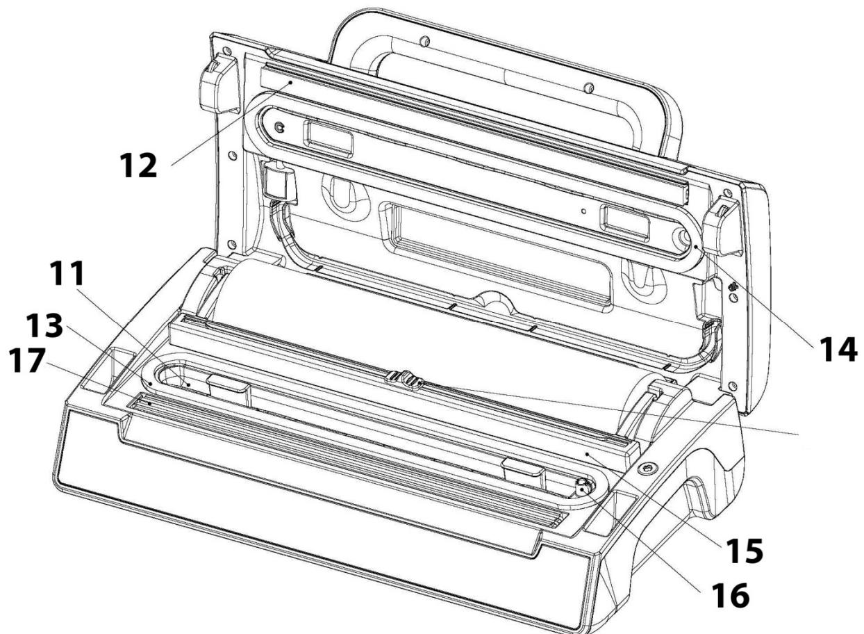
**11 Cámara de vacío:** Coloque la abertura de una bolsa en la cámara.
