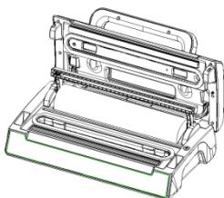
Achten Sie darauf, dass sich der Cutter vor dem Schneiden auf einer Seite der Cutter-Halterung befindet und klappen Sie dann die Cutter-Halterung nach oben.
