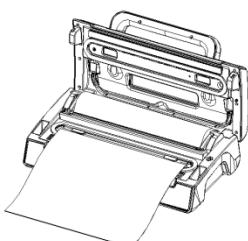
Asegúrese de que el extremo abierto de la bolsa se encuentra dentro de la cámara de vacío.
