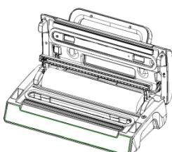
Let erop, dat de cutter voor het snijden aan de kant van de cutterhouder staat en klap vervolgens de cutter-houder naar boven.
