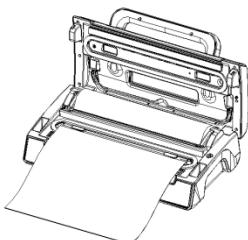
Vérifiez que le bout ouvert du sachet se trouve dans la chambre de dépressurisation pour garantir que l'air ne s'échappe pas. Ne bouchez pas l'entrée d'air.
