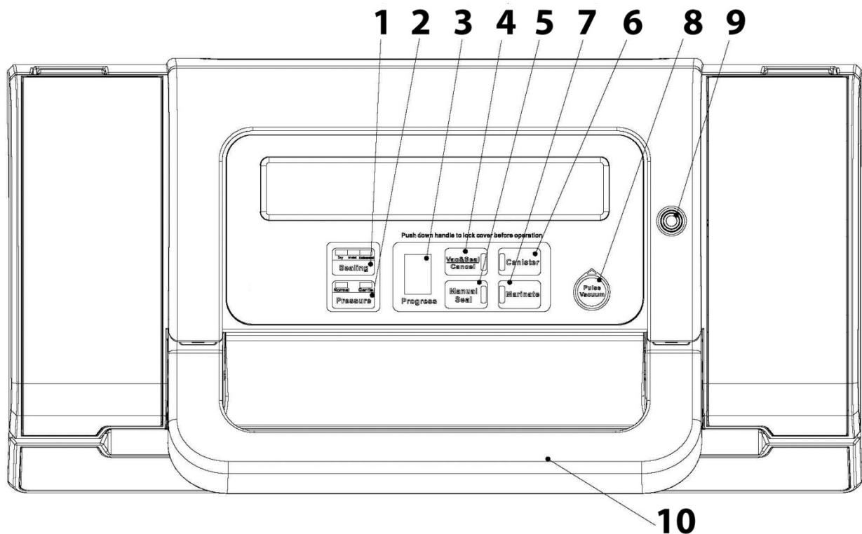
**9 Вакуумная трубка-Подключение:** Для подключения вакуумной трубы для вакуумирования вакуумных контейнеров или винных пробок.
