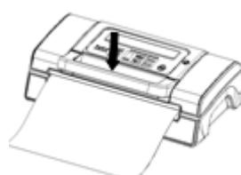
Se volete interrompere la procedura (ad esempio perchè il sacchetto non è posizionato correttamente), premere il pulsante „Interrompi“ ("Vakuum & Schweißen" / „Abbrechen“).
