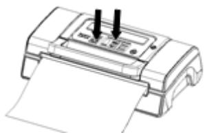
Premere "Sotto vuoto e saldatura" (Vakuum & Schweißen/Abbrechen). Il display conteggia indietro e automaticamente viene aspirata aria. Al termine, il sacchetto viene sigillato, durante ciò la spia di segnalazione „Saldatura manuale“ (Schweißen) è accesa e il display conteggia indietro fino a 0.
