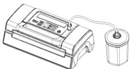
demasiada cantidad de alimento. Cierre la tapa. Fije un extremo del tubo flexible de vacío a la conexión del aparato y otro extremo a la conexión de la tapa del recipiente. Compruebe la indicación de estado LED para observar la intensidad del vacío; debe estar seleccionado el ajuste "suave" (schonend) o "normal" (normal).
