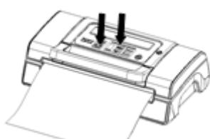
Pulse "Vacío y sellado" ("Vakuum & Schweißen" / „Abbrechen“.). La pantalla realiza la cuenta atrás y se evacúa aire automáticamente. Finalmente se vuelve a sellar la bolsa mientras se ilumina el piloto indicador "Sell manual" (Schweißen) y la pantalla inicia la cuenta atrás hasta 0.
