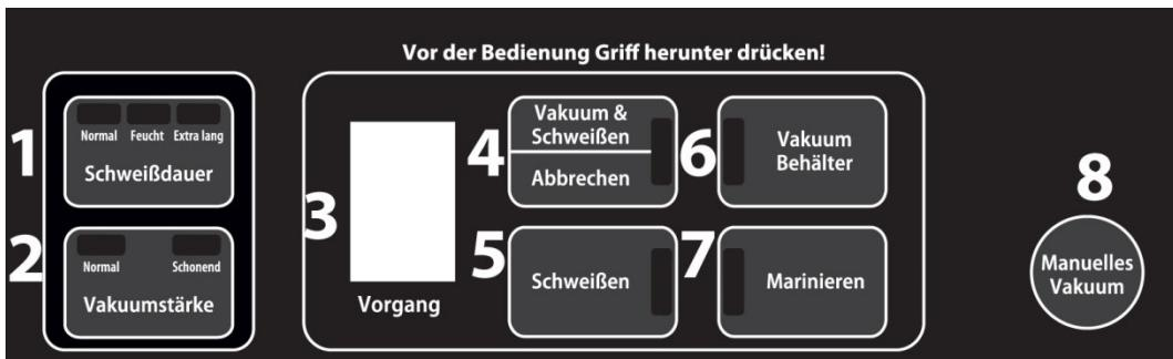
**1 Temps de soudage (Schweißdauer ):** Trois réglages différents pour choisir le temps de soudage.
