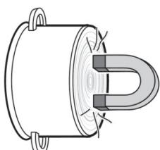
◆ Breng een magneet (bv. een magneet van een magneetbord) naar de bodem van uw pan. Wordt de magneet sterk aangetrokken, dan kunt u deze pan op de inductiekookoppervlakte gebruiken.
