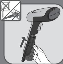
**RU** Установите резервуар на место и задвиньте его до фиксации. Убедитесь, что резервуар установлен правильно.
