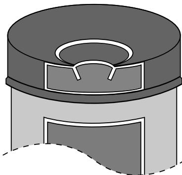
**2.** DE | Aufsteigende Verbrennungsgase werden innen am Flammenlöschkopf gestaut.
