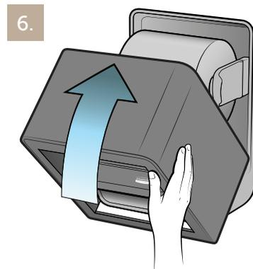
6. Schließen Sie die Abdeckung vollständig und vergewissern Sie sich, dass sie einrastet.
