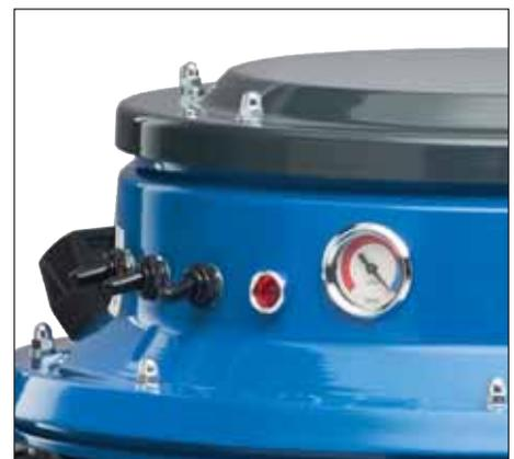
Kontinuierliche Kontrolle der Filterbelegung durch Unterdruckanzeiger
