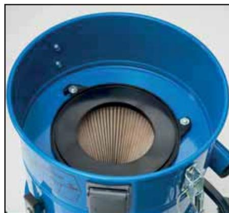
Filterpatrone mit 6 000 cm<sup>2</sup> Filterfläche
