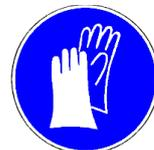
: Spritzschutz: Einmalhandschuh aus Nitrilkautschuk z.B. Dermatril (Schichtdicke: 0,11 mm) der Fa. KCL oder Handschuhe anderer Hersteller mit gleichen Schutzwirkungen. Dauerkontakt: Schutzhandschuh aus Nitrilkautschuk z.B. Camatril (> 480 min, Schichtdicke: 0,40 mm) oder aus Butylkautschuk z.B. Butoject (>480 min, Schichtdicke: 0,70 mm) der Fa. KCL oder Handschuhe anderer Hersteller mit gleichen Schutzwirkungen.
